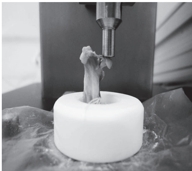
Obr. 2 Testování odolnosti krčku femuru v tlaku
